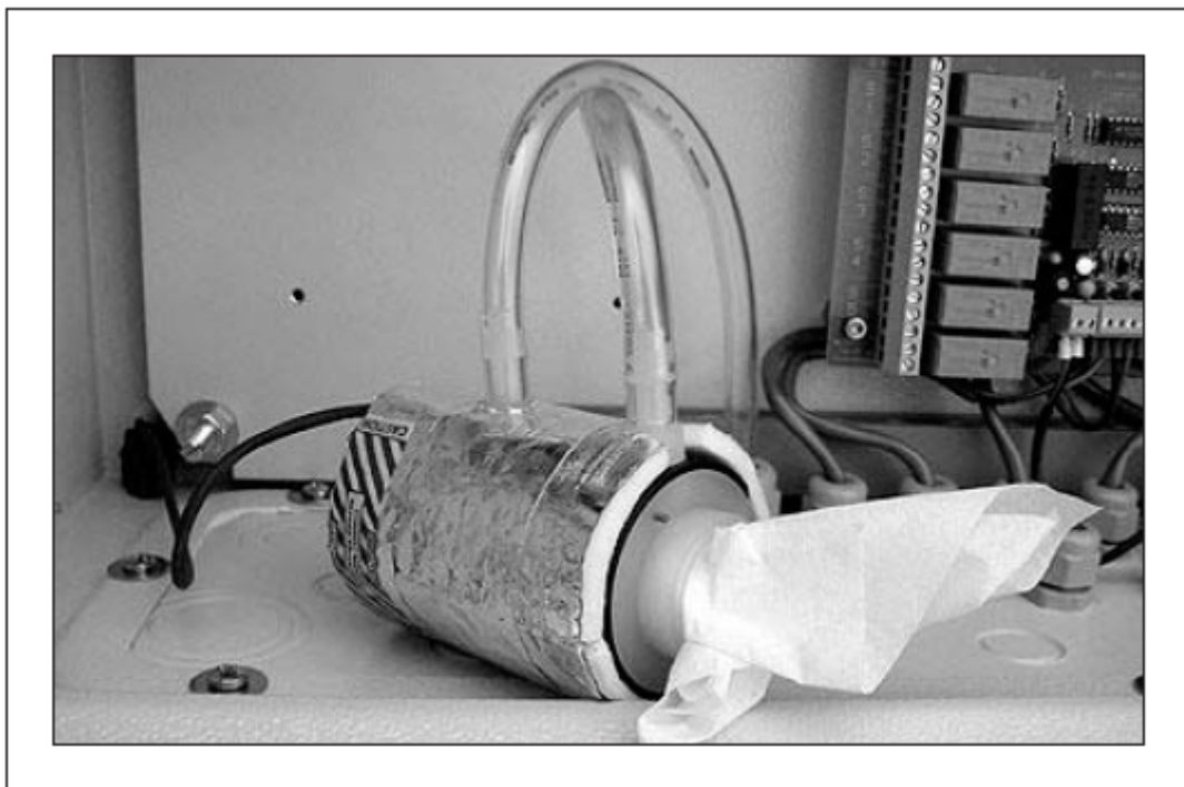
图 7-52 清洗 IR 室组件的内壁
